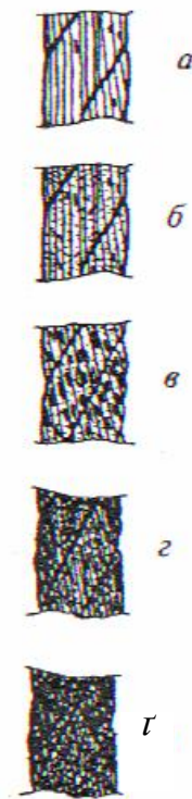
Рис. 1.6. Поверхнева корозія дротів каната хрестової звивки: а - початкове окислення поверхні; б - загальне окислення поверхні; в - помітне окислення; г - значне окислення. r - інтенсивна корозія
