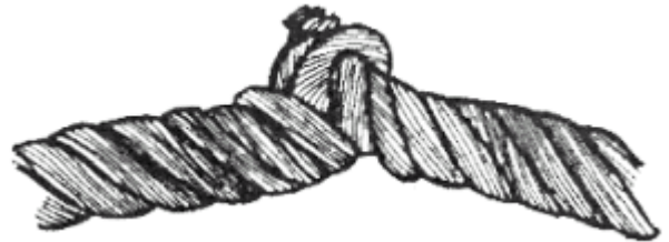
Рис. 10.7. Місцеве зменшення діаметра каната на місці руйнування органічного осердя
